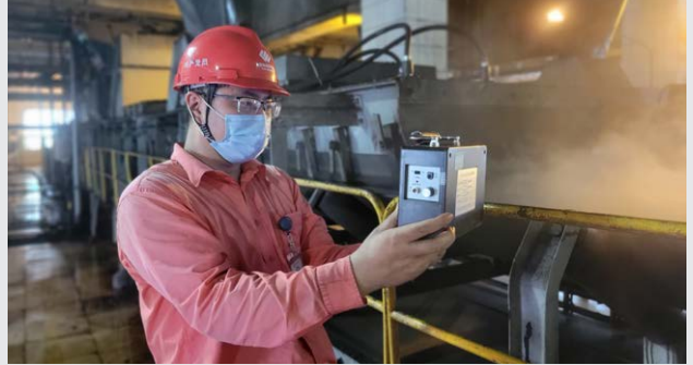
燃料人员测量干雾抑尘装置启动后环境粉尘浓度
